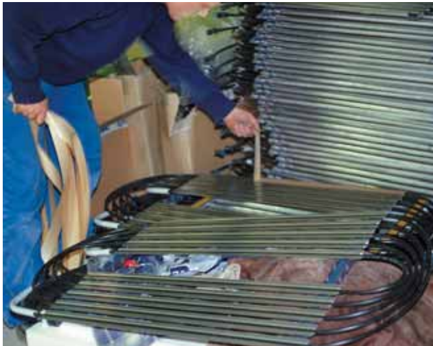
Montáž topných těles do stropních panelů pomocí 3M VHB TM pásky 9473, která dlouhodobě odolává vyšším teplotám.
