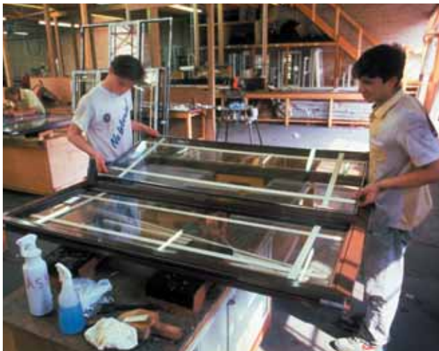
Lepení dekoracních lišt na skleněná okna pomocí 3M VHB TM pásky, dlouhodobě odolávající vnějším povětrnostním podmínkám.
