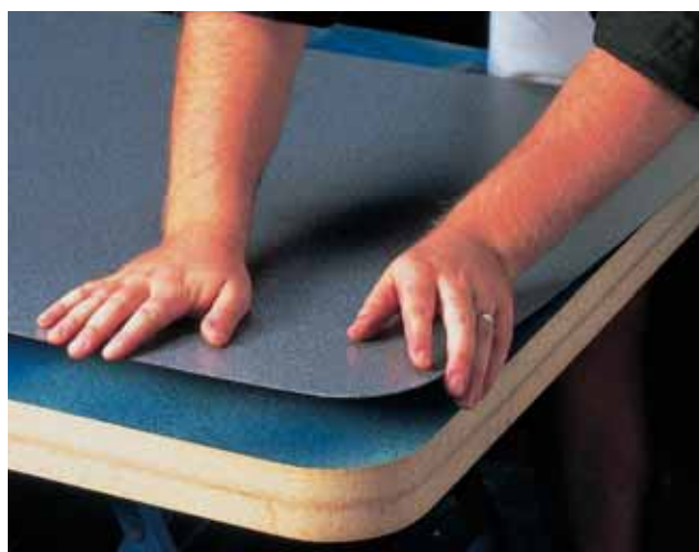
Lepení laminátových desek na dřevotřísku
