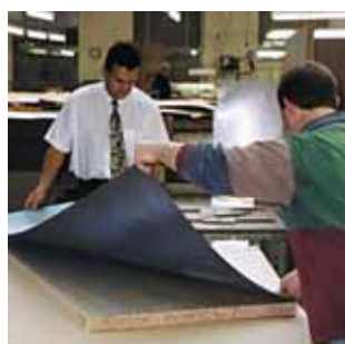
Lepení laminátu a dýhy ke dřevu (dveře)
