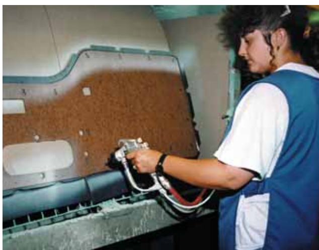
Lepení pěnové hmoty ke dřevu, plsti k oceli nebo dřevovláknité desce
