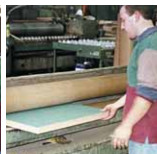
Lepení laminátu a dýhy ke dřevu (dveře)
